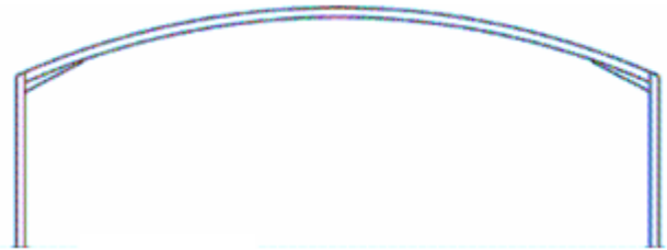
Figura 17 – Exemplo de pórtico em arco
