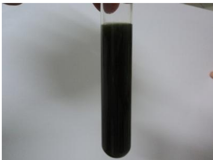
Teste de alcalóides-após adição do reagente de Wagner (turbidez, separação de fases e mudança de coloração – marrom/verde)
