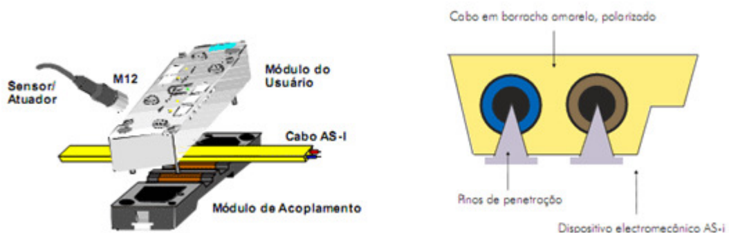
Figura 10 - Conexão do Cabo AS-I
