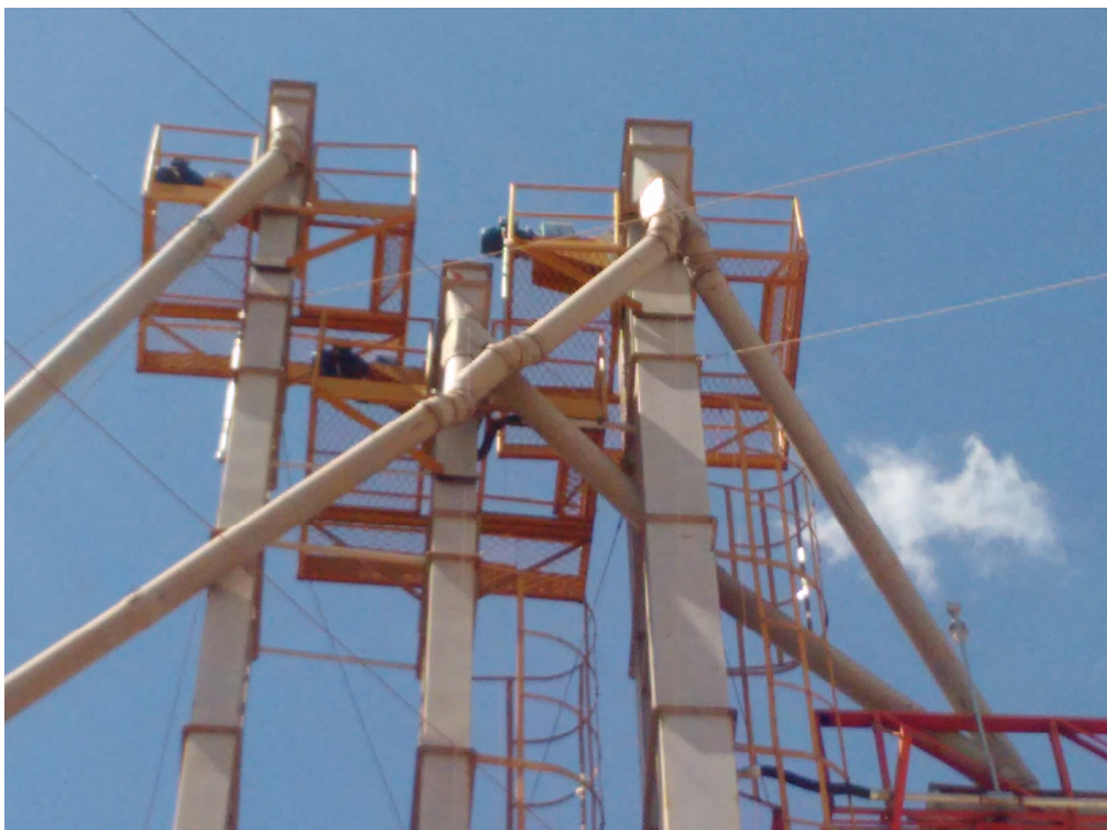
Figura 32 - Direcionadora de fluxo expedição e estocagem
