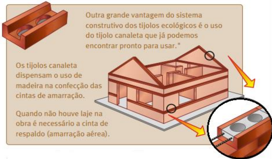
Figura 26: Amarração que substitui vergas e contra-vergas
