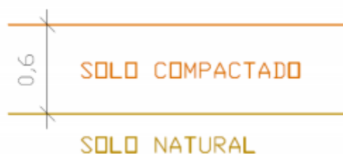
Figura 11 – Esquema da configuração da camada de fundo
