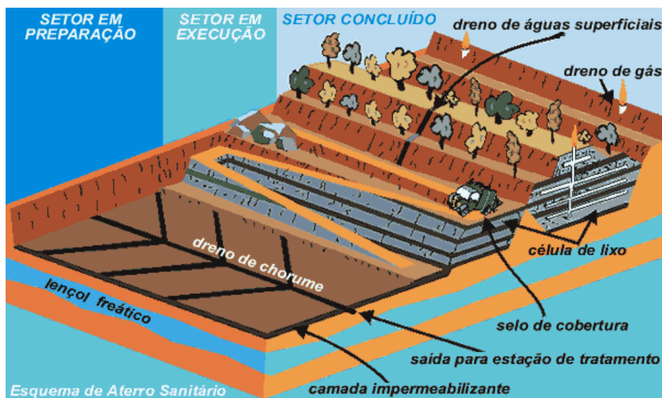
Figura 7 – Esquema de um Aterro Sanitário
