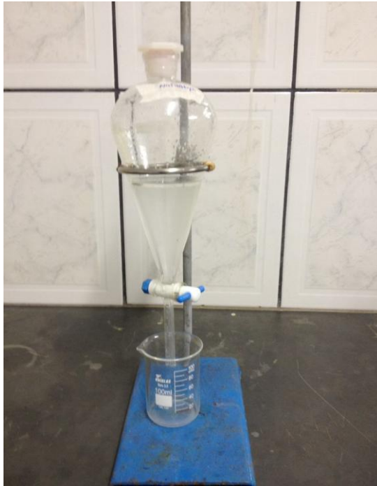
Figura 07: A purificação foi realizada em triplicata, utilizando éter etílico e um funil de separação.
