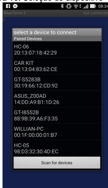
Após a seleção do dispositivo bluetooth a interface abre o teclado do Android para o envio de comandos. Os comandos são especificados de acordo com o programa feito para o Arduino.
