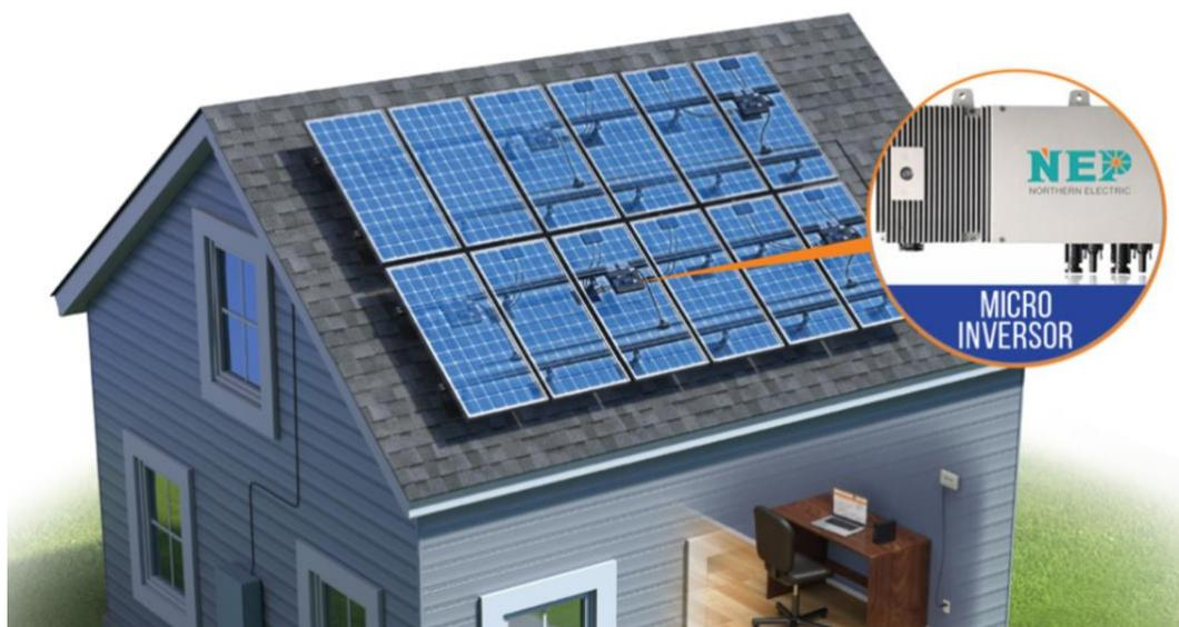
Figura 15 – Instalação residencial de micro inversores
