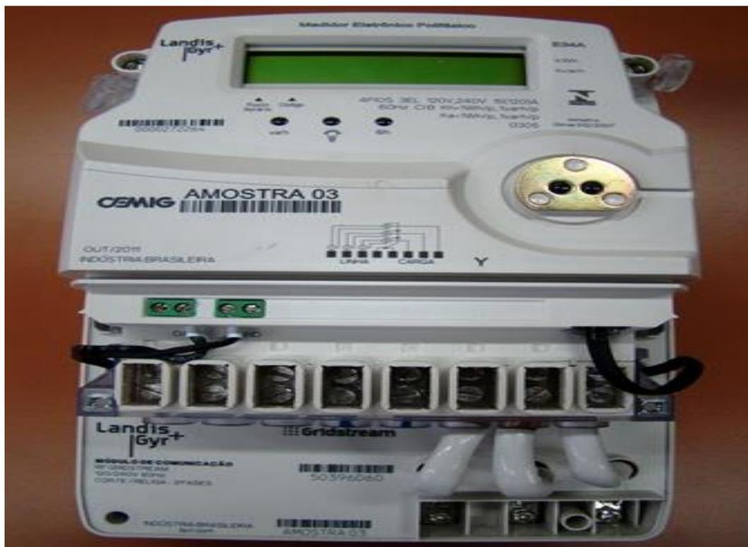
Figura 11 - Medidor Bidirecional amostra
