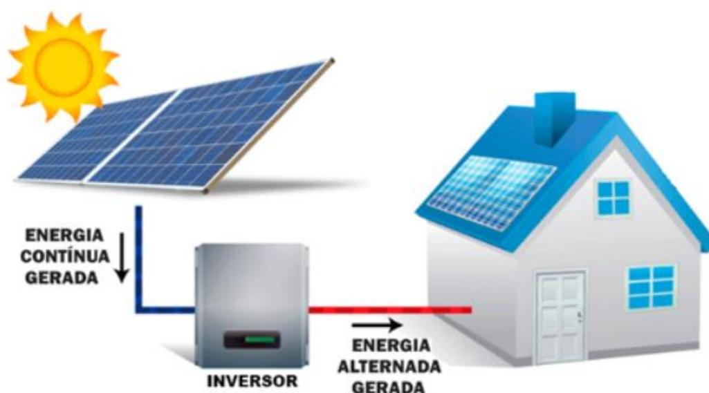
Figura 12 – esquema com um inversor fotovoltaico
