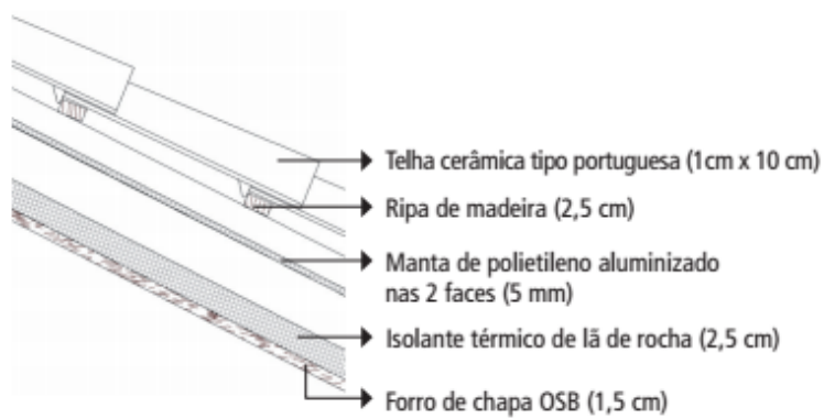
Figura 21 – Propriedades termo físicas da cobertura cerâmica com isolamento
