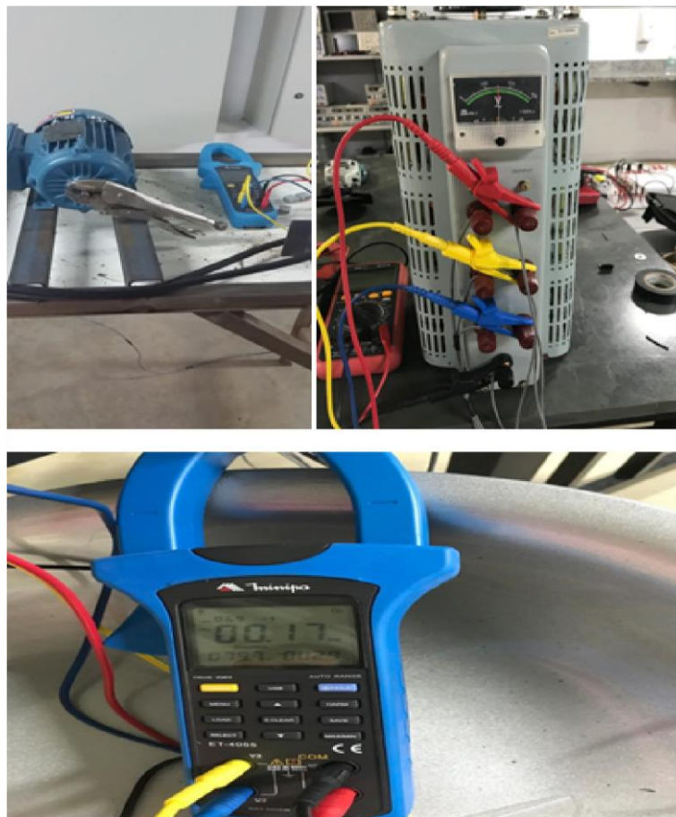
Figura 10 - ensaios rotor bloqueado
