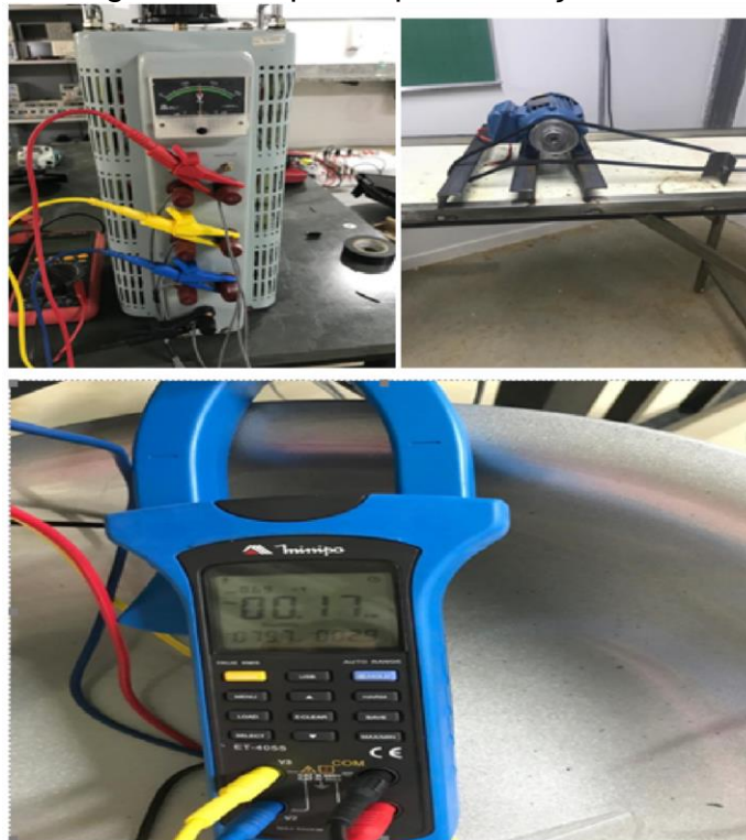
Figura 9 - Esquema para Medição do Ensaio a Vazio
