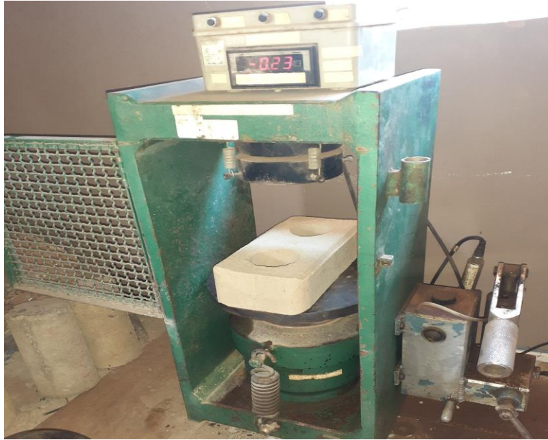
Figura 16 – Ensaio de resistência à compressão.
