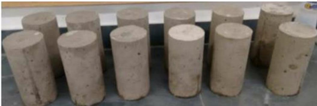
Figura 5 – Corpo de prova cilíndrico (fck 25 MPa e fck 35 MPa)
