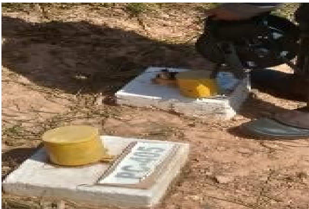
Figura 16. Leitura dos Piezômetro Retiro Baixo (Fonte: Documentos Operacionais da UHE Retiro Baixo, 2019).
