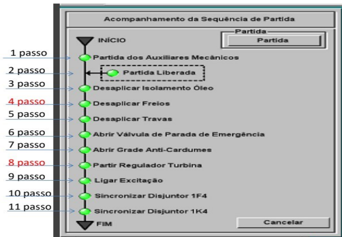
Figura 27. Acompanhamento da sequência de partida UHE Retiro Baixo (Fonte: Sistema de Supervisão e Controle UHE Retiro Baixo, 2019).
